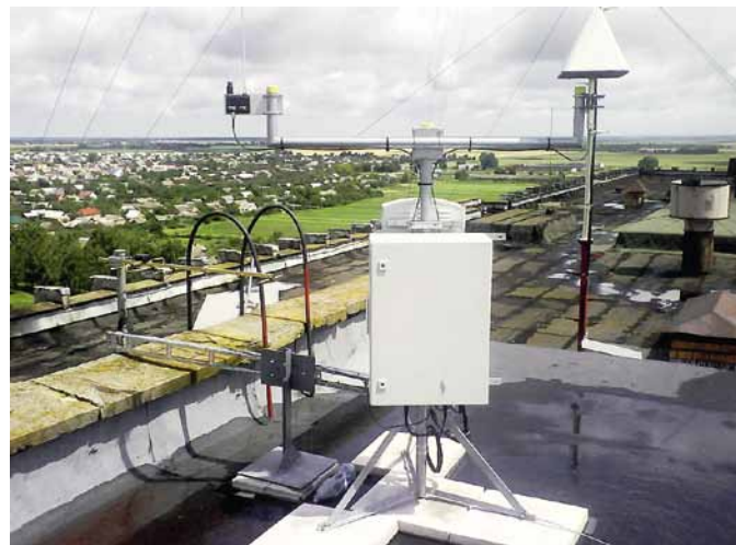
BILD 3 Mit einem Stativ sind die Monitoring-Systeme R&S®UMS100 auch problemlos auf dem Flachdach eines Hochhauses aufgestellt.
