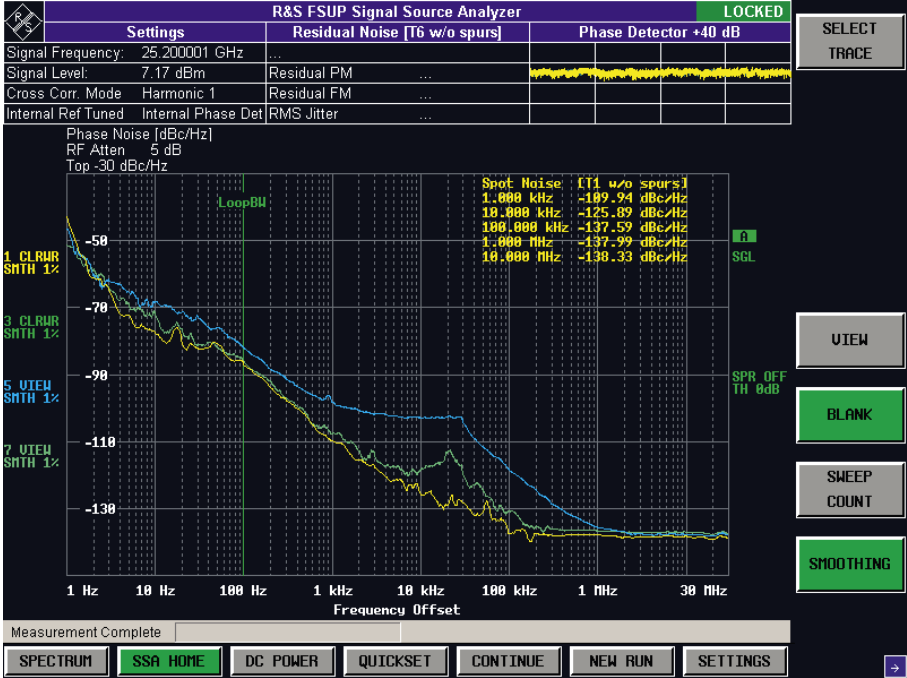
BILD 2 Ergebnisse einer Phasenrauschenmessung mit dem R&S®FSUP an einer sehr guten Signalquelle.
