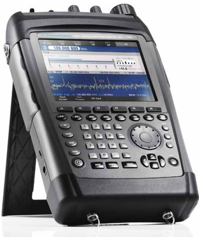
BILD 5 Tragbarer Empfänger R&S®PR100 mit den Antennen R&S®HE300.
